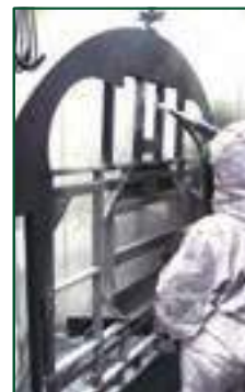
5. Fabricación de elementos en corte láser, soldaduras MIG, TIG
