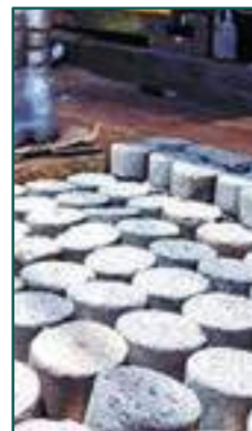
5. Briquetas como recuperación de limadura de metal
