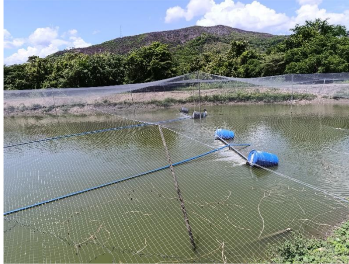
Ilustración 2. Sistemas de aireación con deflectores y sistema de control de predadores piscícola HSF S.A.S.
